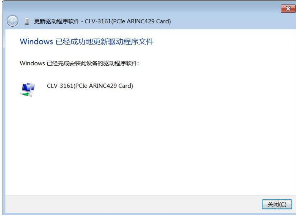
点击关闭,驱动程序安装完成,在设备管理器中可以看到 PCI Arinc429 设备;
